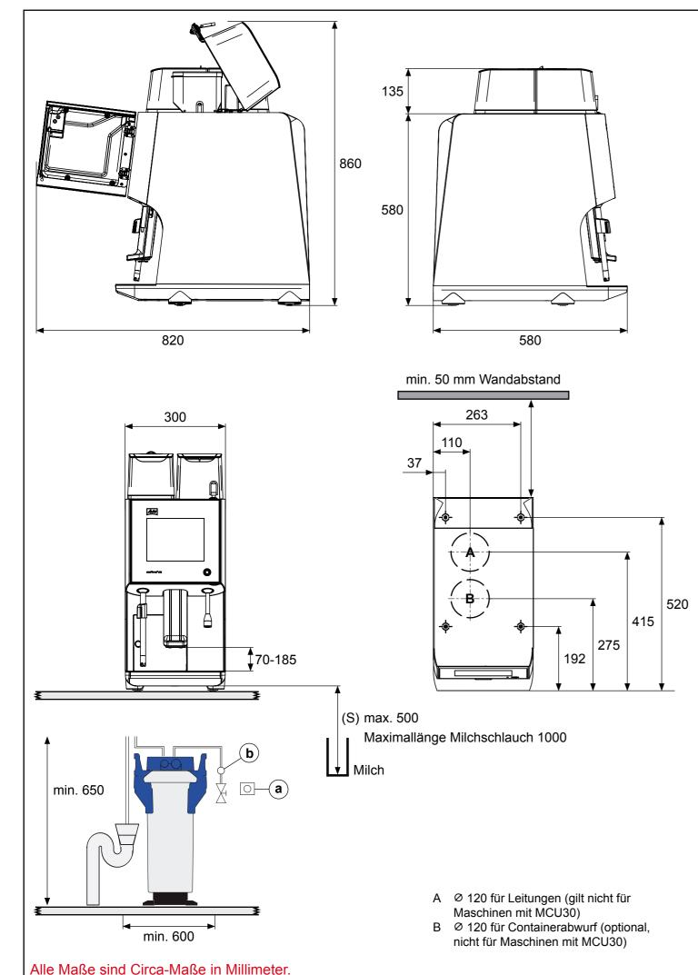
Die Melitta® Cafina® XT5 wird anschlussfertig geliefert. Vor dem Aufstellen müssen jedoch die bauseits notwendigen Anschlüsse gut zugänglich innerhalb eines Radius von 1 m installiert sein. Diese Vorarbeiten müssen von konzessionierten Fachleuten unter Beachtung der gültigen Vorschriften ausgeführt werden. Der Melitta® Kundendienst ist hierzu nicht berechtigt und übernimmt keinerlei Verantwortung für die Installation.
